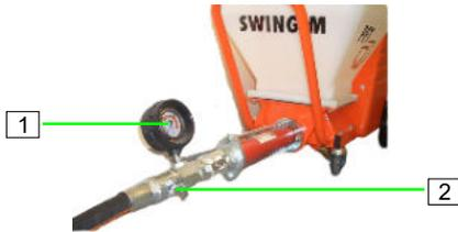
Abb. 43: Mörtelschlauch abkuppeln
