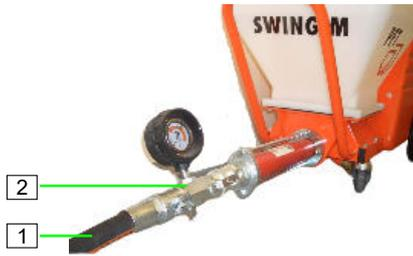
Abb. 21: Mörtelschlauch anschließen
