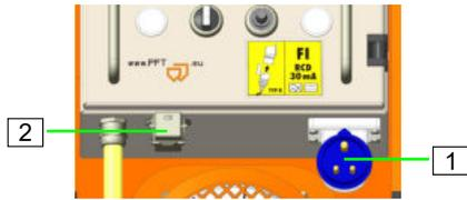
Abb. 19: Stromversorgung anschließen
